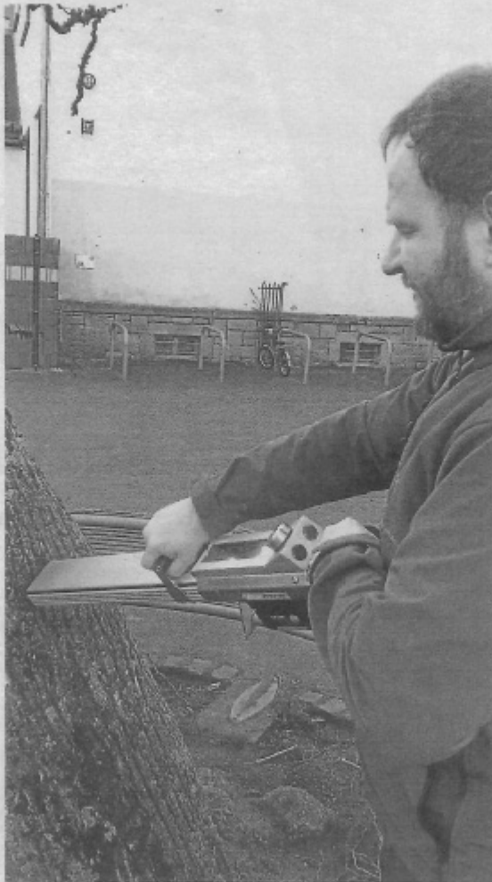
Mit einem Resistograph wird der Fäulnisgrad der Sommerlinde hinter der Kirche in Nieder-Roden gemessen. ANNETTE SCHLEGEL
